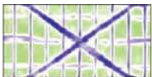
Slika 113. Radargram armature snimljene u betonskoj konstrukciji, dokumentacija GSSI.
