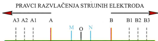
Slika 53. Princip merenja kod električnog sondiranja.
