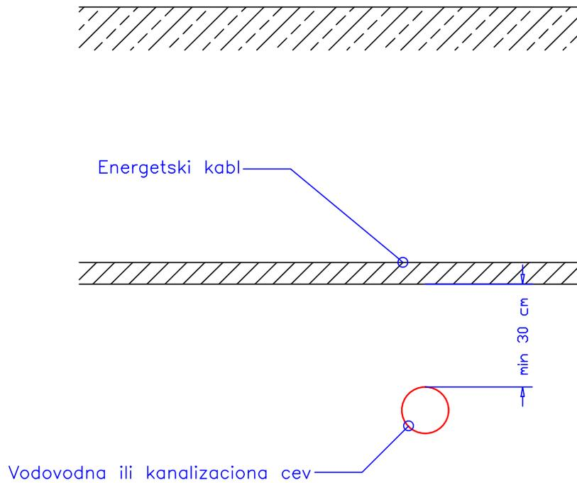
Horizontalno rastojanje izmedju kablovskih vodova i vodovoda i kanalizacije
